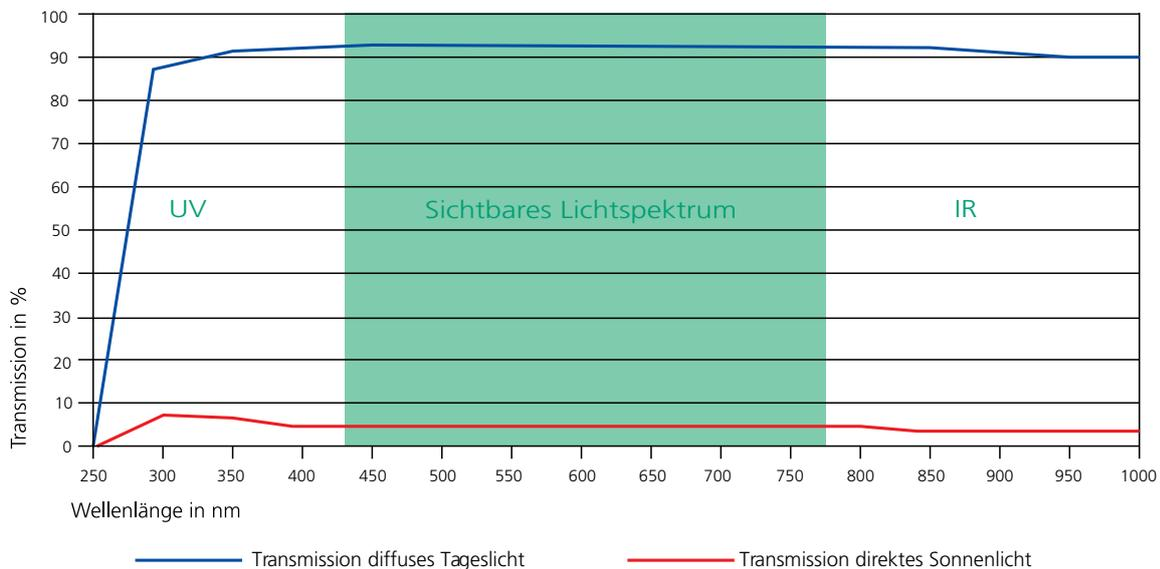
Grafisch dargestellt sind die Anteile des diffusen Tageslichts (blau) und der direkten (gerichteten, wärmetragenden) Sonnenstrahlung (rot), die von einer PrismaReflect Vertikalanlage unter optimalen Einsatzbedingungen durchgelassen werden. Vereinfachte Darstellung; Datenquelle: Evonik Röhm GmbH
