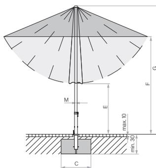
Looser Deckbelag max. 10 cm, Betondicke min. 30 cm (Frosttiefe beachten), Wasserabfluss.
